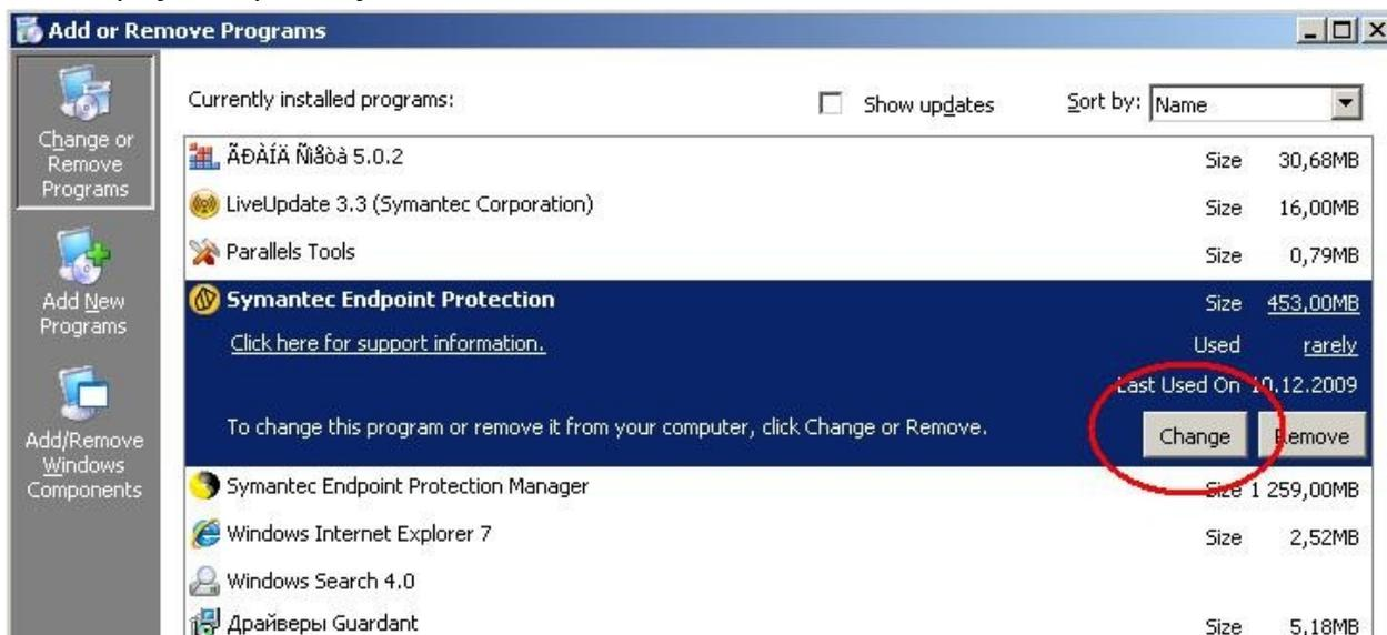
Ждем когда установщик прогрузится, нажимаем кнопку далее, выбираем пункт "Изменить", опять далее и на появившемся диалоге отключаем "Управление приложениями и устройствами" (Application and Device Control)
